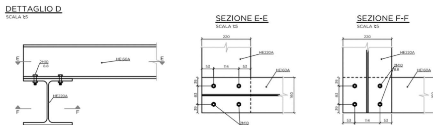
Figura - Dettaglio D della passerella Ovest
